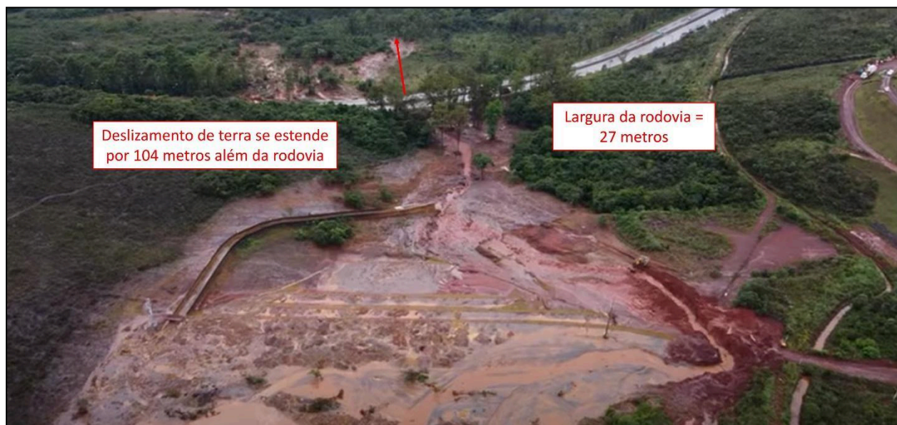
Figura 4a. Com base na largura da rodovia de 27 metros, o deslizamento de materiais na instalação de armazenamento de rejeitados filtrados na mina de Pau Branco no Brasil em 8 de janeiro de 2022 (ver Fig. 3), estendeu-se por 104 metros após a rodovia BR-40. A largura da rodovia foi medida a partir da imagem do Google Earth de 29 de junho de 2022 (ver Fig. 4b). Imagem fixa em 0:38 do vídeo de drone (Observatório da Mineração, 2022).
